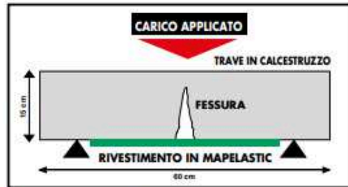
Fig. 1: Protezione con Mapelastic di una fessura all'intradosso di una trave in calcestruzzo sottoposta ad una sollecitazione flessionale.
